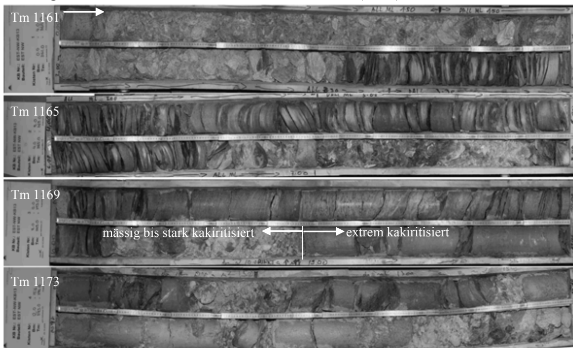
Figur 8. Bohrkern aus der Vorauserkundung in der Weströhre (Tm 1161 – 1177). Tm 1161 – 1171.8 mit einer Wechselfolge von schwach und mässig, z.T. stark zerscherten, zu Kies zerfallenen Schiefen (bautechnisch als mässig bis stark kakiritisierte Zone ausgeschieden), ab Tm 1171.8 mit einem Lehmkakirit (bautechnisch als extrem kakiritisiert ausgeschieden). Der dargestellte Übergang stellt den Beginn des druckhaften Gebirges dar.
