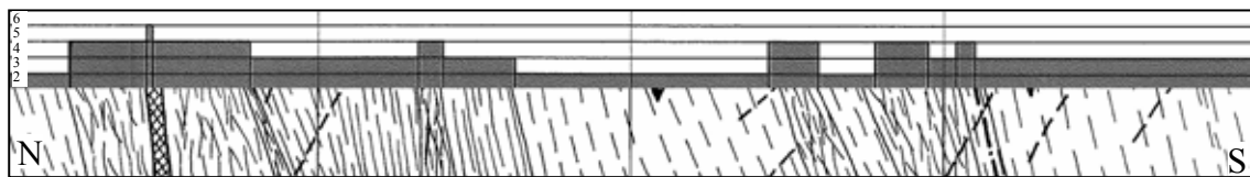
a) Nordvortrieb Weströhre Tm 1080 bis 1120: Strecke mit intakt bis gering zerscherten Gesteinen
