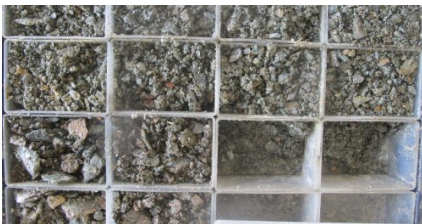
Bohrkleinproben zur Beurteilung der geologischen Verhältnisse hinter dem Mauerwerk
