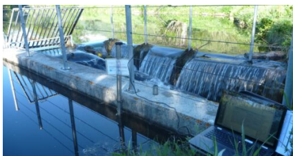
Pegelmessung an einem Oberflächengewässer.
