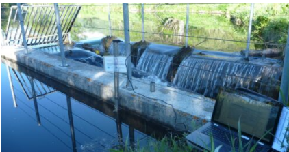
Pegelmessung an einem Oberflächengewässer.
