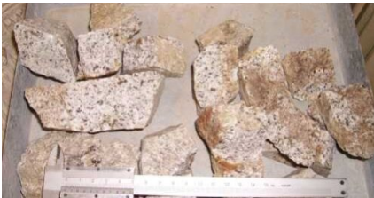
Härteuntersuche (Point Load Test) am Julier Granit.
