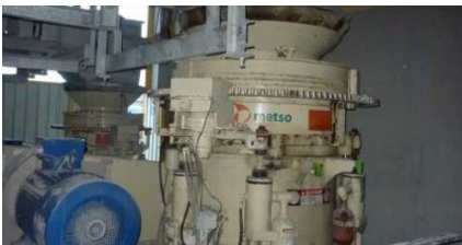
Das Nachbrechen des Überkorns erfolgte mittels eines Kegelbrechers (Spalteinstellung 12mm).
