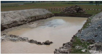
Schlammabsetzung während Pumpversuch.
