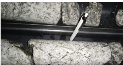
Bild 3: Aufnahme von Bohrkernen mit feinsten hydraulisch wirksamen Strukturen zur Beurteilung der mittels Bohrlochversuchen bestimmten Durchlässigkeiten
